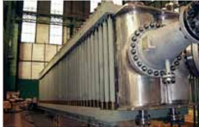
**Packinox** 重达 350 吨，通常仅需一台即可满足热储存系统所需的换热需求。
